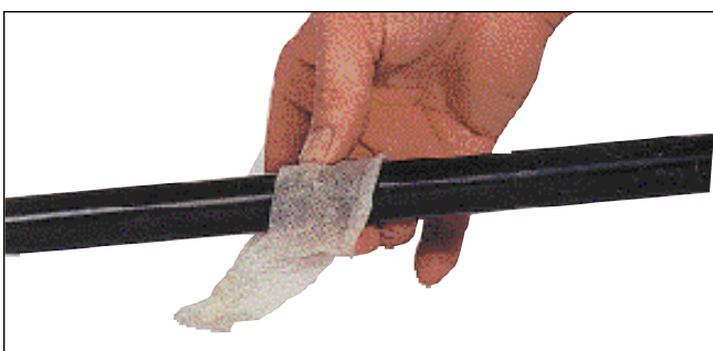
Foto 7: Brug en bomuldsklud med lidt olie på og tør piben og alle metaldele over med kluden.
