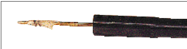
Foto 6: Tag kluden af og træk rensesstocken tilbage igen. Hvis kluden er meget sort, så træk en ny igennem.
