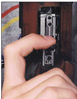
Forkert placering af finger på aftrækkeren, den bliver trukket skævt, det kan ikke gøres ens for hver gang og vil samtidig påvirke geværet i skudafgangen
